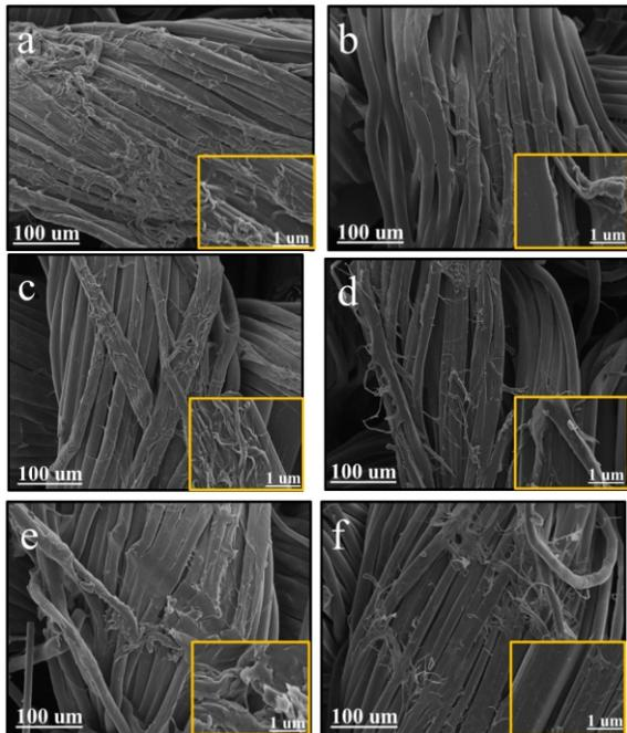
Fig. 4. SEM images of (a) Lyocell fabric, (b) LC/CS, (c) LC0.3, (d) LC0.6, (e) LC0.9 and (f) LC1.2.
