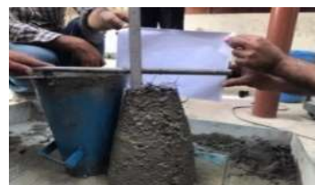
b) Slump test
